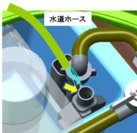
放流エアリフトポンプの洗浄イメージ
