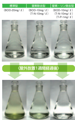
浄化槽処理水の経日変化比較
