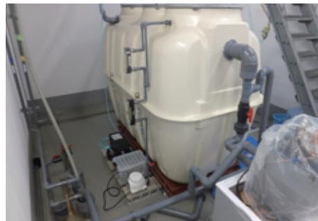
▲性能評価試験用の試作浄化槽
