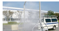
車輦消毒装置 鶏インフルエンザ対策として開発。ゲート型車輦消毒装置は、上下左右から車輦を消毒。
