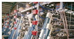
ヒナ段式ケージシステム 高床式、低床式のヒナ段ケージに絶大な実績を持つヨシダ式全自動養鶏システム。
