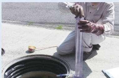
▲処理水の透視度の測定
