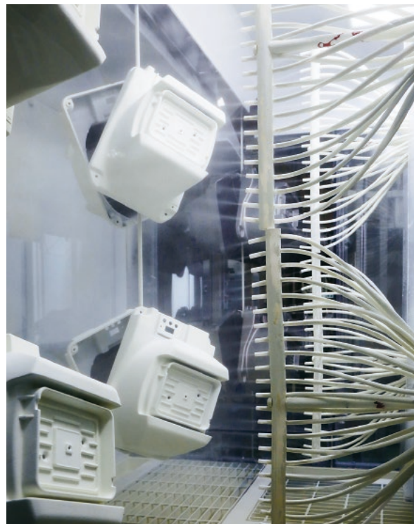
電磁式ブロワの塗装整備ライン
