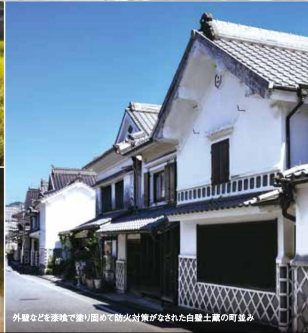
外壁などを漆喰で塗り固めて防火対策がなされた白壁土蔵の町並み
